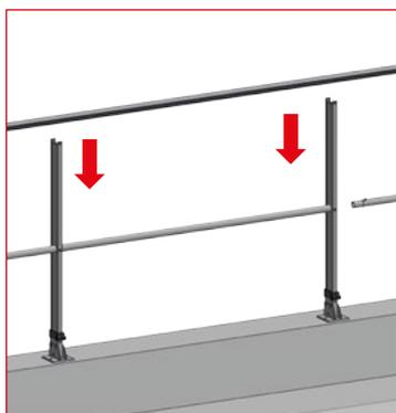
**4 -** Clipser la main courante dans les montants. Fixez-la avec la vis autoforeuse 4,8x32. Couple de serrage recommandé 5 N.m.
