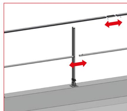
**6 -** Assembler les mains courantes avec les jonctions et les sous-lisses des tronçons montés. Fixer chaque jonction avec les vis 4,8 x 32 : 2 à chaque jonction de main courante et 1 entre 2 sous-lisse.
