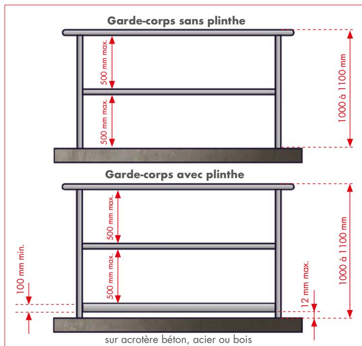
S'il existe une ouverture plus grande, un portillon permettant d'assurer la continuité de la sécurité antichute du garde-corps doit être mis en place.
