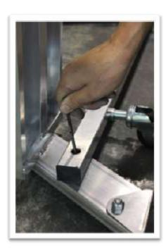
➤ Étape 4 : Resserrer totalement les boulons de la plate-forme
