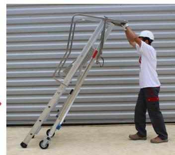
Mettre la plate-forme en appui sur le plan de montée
