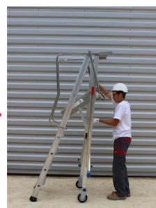
Soulever la plate-forme, pousser le plan de support en s'appuyant sur le plan de montée
