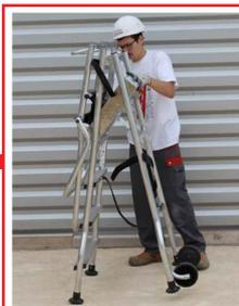
Déverrouiller le crochet anti-soulèvement, soulever la plate-forme en repliant le plan de support sur le plan de montée.
