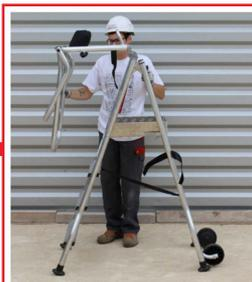
Replier le garde-corps sur le plan de montée.
