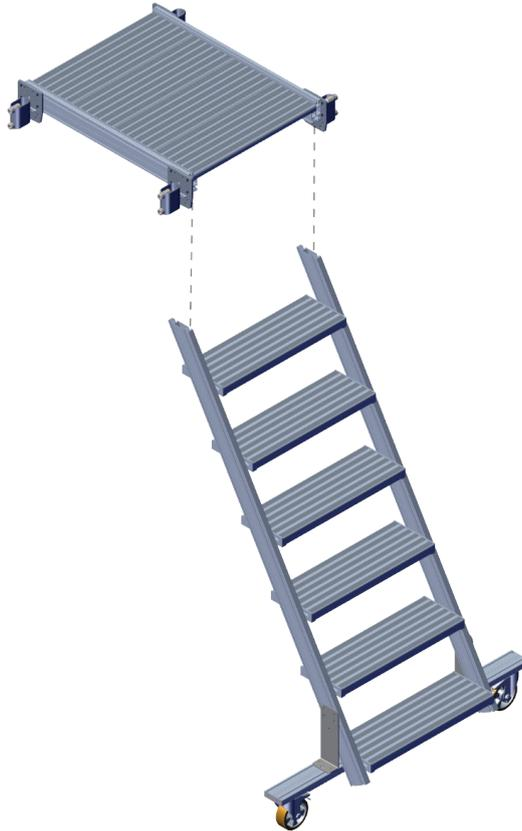
**2.2** Aligner le plan de montée et le bord du profilé de plateforme.
