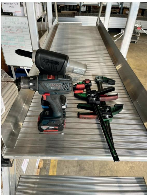
**ETAPE 3** : Pour l'installation du portillon, vous aurez besoin de 2 serre-joints, d'une perceuse, d'un foret Ø5 et d'une riveteuse.
