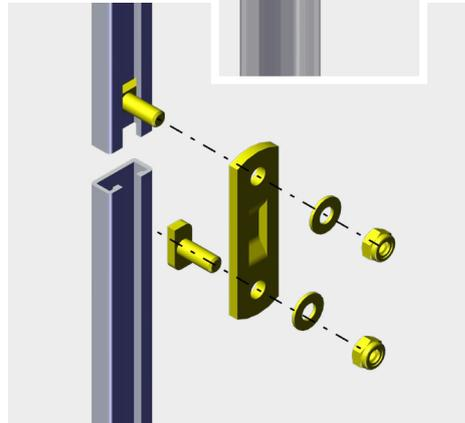
La pièce de jonction de filants dispose d'un détrompeur qui doit être positionné dans les deux gorges des profilés et être centré sur le point de jonction des filants.
