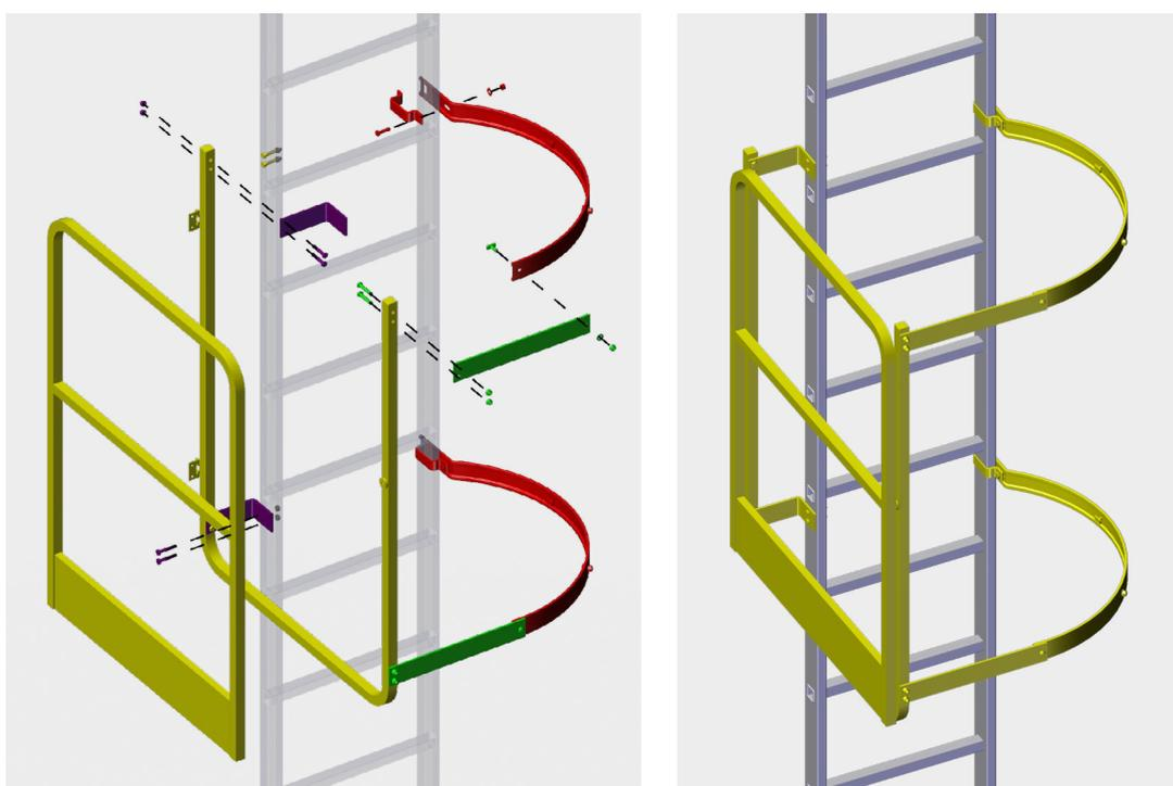
La sortie latérale est composée de deux arceaux recevant 3 filants, 2 éléments droit de liaison, un cadre recevant un portillon et 2 pattes permettant de fixer le cadre sur le montant de l'échelle.
