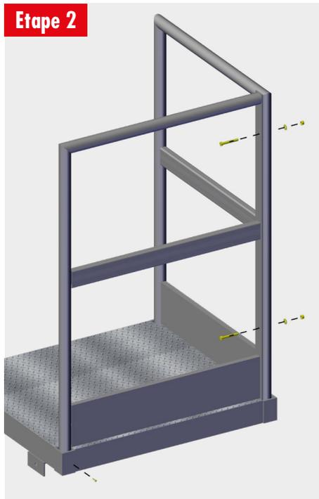
Enficher le second garde-corps. Solidariser ce garde-corps au moyen d'une vis auto-foreuse.
