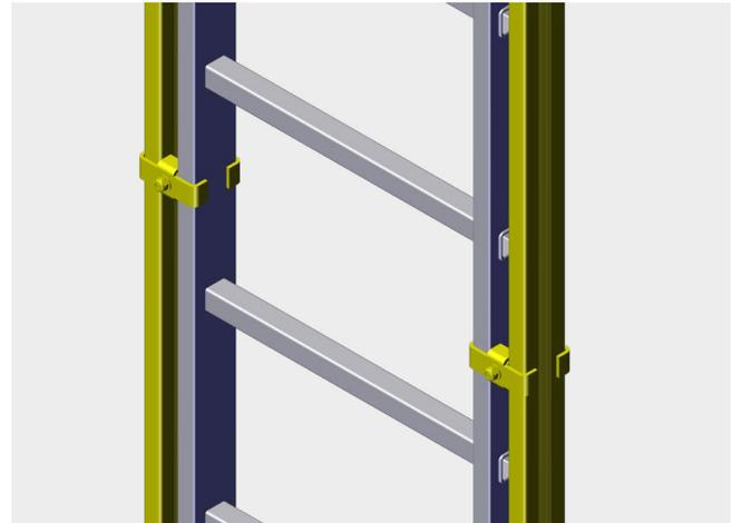
Fixer les tubes latéraux de renfort aux montants de l'échelle à l'aide des brides et vis à col M8x80.
