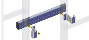
Fixer la main courante entre 1 m et 1 m 10 au-dessus du palier, entre les deux échelles, au moyen de vis halfen M8x20
