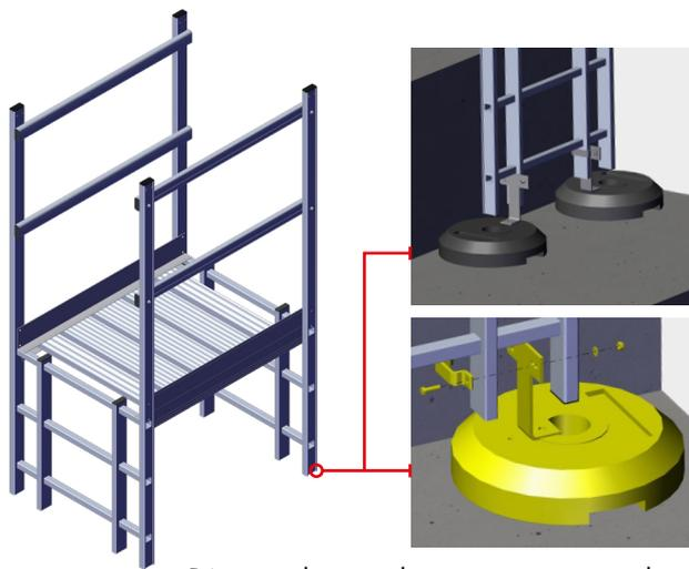
Démonter les manchons pour mettre en place les pattes de fixation sur plots
