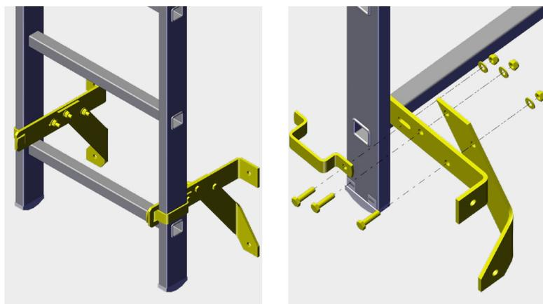
Les pattes de fixation renforcées sont positionnées en partie basse à 300 mm maximum du sol. Préconisées dans le cas où l'échelle n'est pas fixée ou ne repose pas au sol, les pattes renforcées sont aussi utilisées au départ d'un changement de volée.
