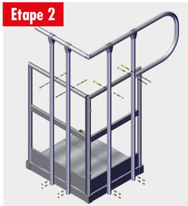
Positionner les garde-corps, pour marquer puis percer en Ø9mm le palier et la main courante, puis fixer les garde-corps au moyen de vis H M8x90.
