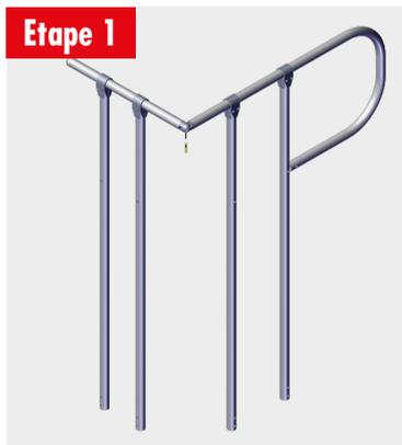
Assembler les garde-corps au moyen de vis CHC M6x25.
