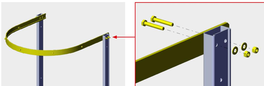
L'arceau de sortie doit être positionné entre les faces intérieures des montants de sortie.
