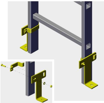
Pour la fixation au sol du premier élément d'échelle ou des passerelles de passage d'acrotères côté redescente sur l'aire d'arrivée. Le sol doit être stable et compatible (dalle béton par exemple).
