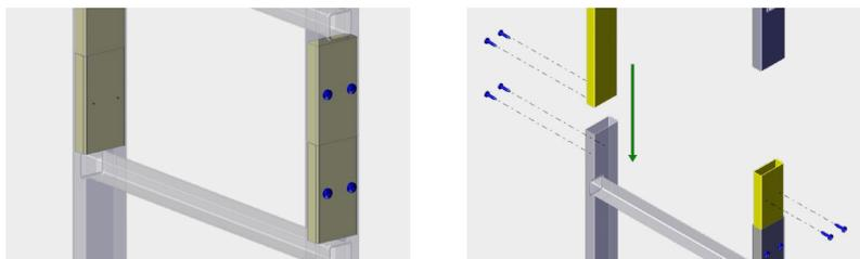
1. La jonction entre deux échelles est réalisée grâce aux deux manchons introduits dans les montants jusqu'en butée.
