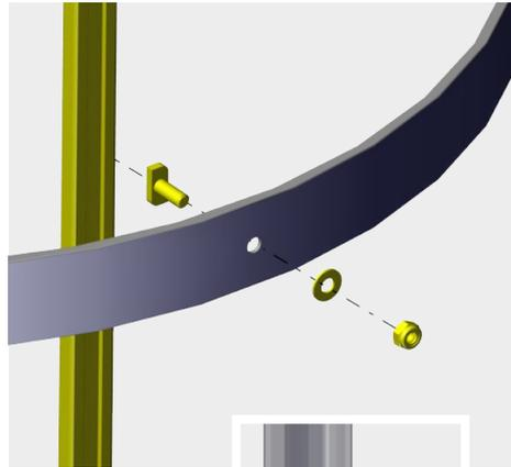
Les filants doivent être positionnés sur la face intérieure des arceaux.
