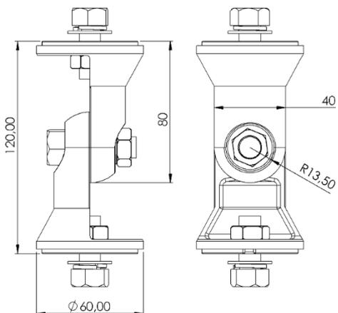
**Descriptif :** L'articulation permet de compenser les angles pour fixer les lignes de vie CONEKT sur la charpente.
