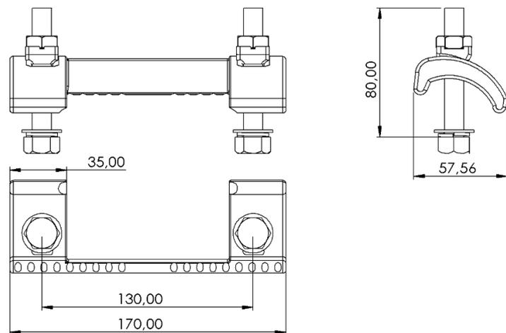
*Descriptif :* Le crapaud double CONEKT peut être utilisé directement sur les poteaux standards ou sur-mesure.
