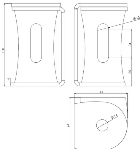
*Descriptif* : Le RH100 est conçue pour recevoir les lignes de vie CONEKT rail et câble ainsi que tout type de point d'ancrage NF EN 795 type A, C ou D de marque CONEKT.
