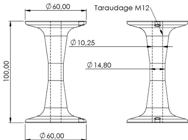
*Descriptif* : Le diabolo permet de fixer un absorbeur ou un tendeur de la gamme CONEKT sur les interfaces sur couverture de type ICJD, ICZ, ou ICA. Doit être monté à l'aide d'une vis traversante M10 x 140 inox.
