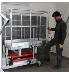
Élévation hydraulique de la plate-forme par simple appui
